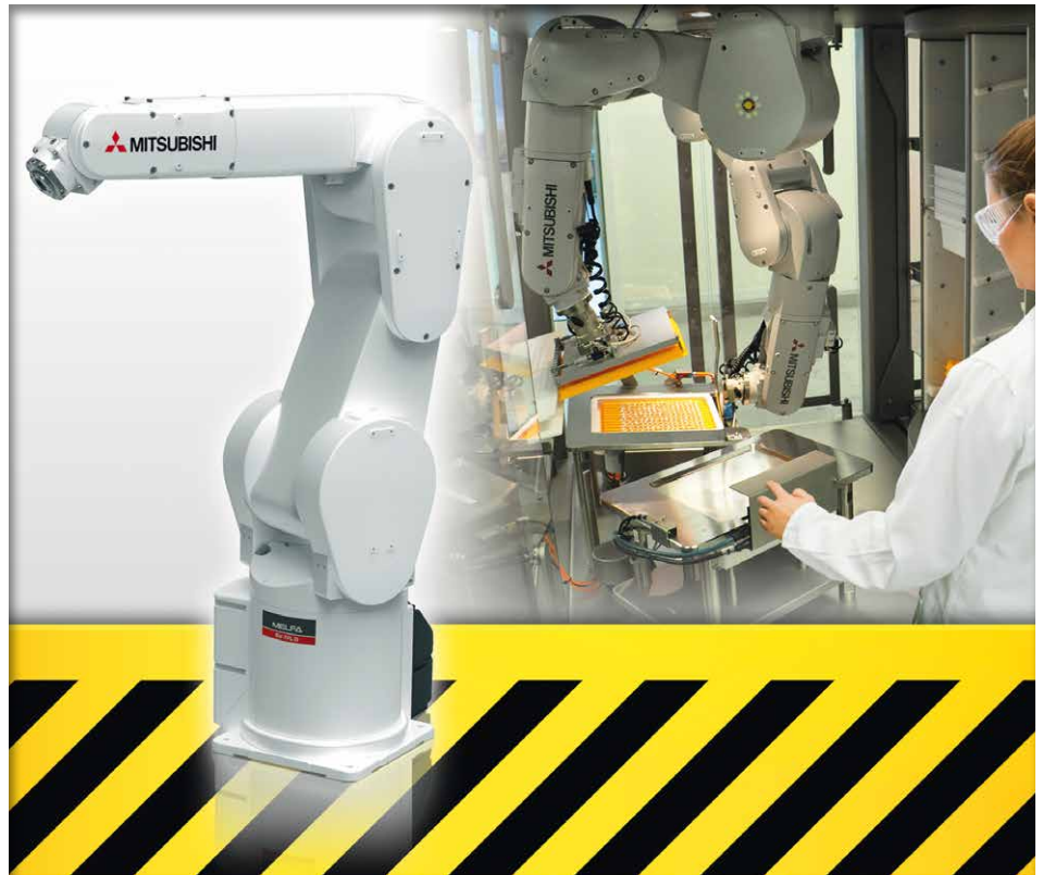
Mit der neuen integrierten Sicherheitslösung „MELFA SafePlus“ können Roboter der Mitsubishi Electric F-Serie und Bedienpersonal zusammenarbeiten, was zu Platz- und Kosteneinsparungen sowie zur Produktivitätssteigerung beiträgt.
