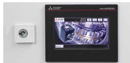
Das SCM ermöglicht eine Analyse mit detaillierter Diagnose. Die vom Schwingungssensor ermittelten Daten werden im Sensor-Controller aufbereitet und an der Bedienanzeige als Status oder Klartextalarm mit Wartungsmaßnahme angezeigt, durch die dann eine Wartungsaktion zeitlich geplant werden kann.
