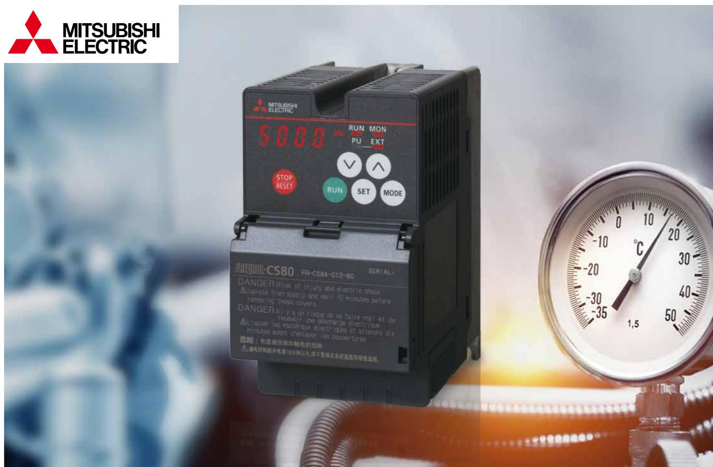
Der FR-CS80 ist der neue kostenoptimierte Frequenzumrichter von Mitsubishi Electric. Mit der kompaktesten Bauform in seiner Klasse setzt er zudem bei Zuverlässigkeit und Qualität die höchsten Maßstäbe. Die kostengünstigen Frequenzumrichter der FR-CS80 Klasse decken einen Leistungsbereich von 0,4 bis 15 kW mit einer Netzspannung von 1 ph 200 V oder 3 ph 400 V ab.
